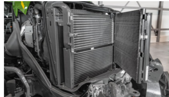
Weniger Aufwand: Das kompakte Kühlerpaket ist sehr gut zugänglich und lässt sich dank der großen Abstände zwischen den Kühlern und dem ebenen Kühlerboden einfach und schnell reinigen.
