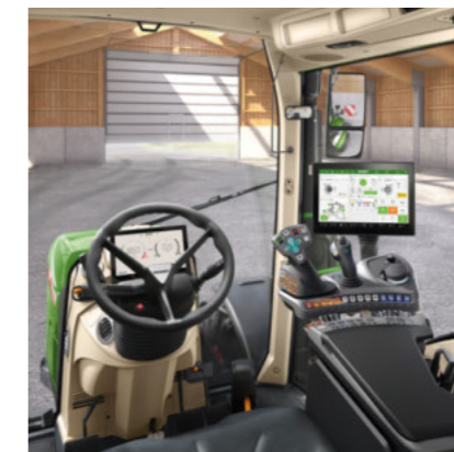
Profi Setting 2 - 3L-Joystick - Ein Linearmodul (Rockerpaar) zur Bedienung Hydraulikventile - 12" Terminal
