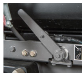
Verhindert Schäden an angehängten Geräten und Fehlbedienung: die Fixierung der Unterlenker über den Absperrrahm.
