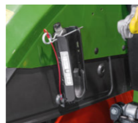
Sicherer Aufbewahrungsort: der voll integrierte Kugelhalter am inneren Kotflügel.
