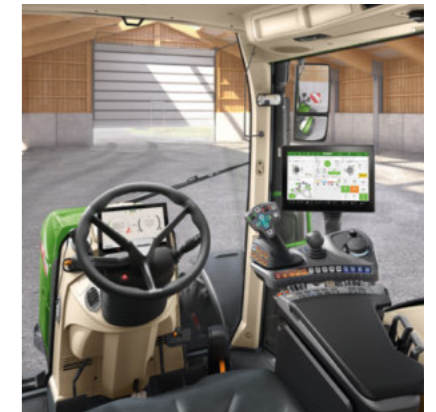
Profi+ Setting 1 - Kreuzschalthebel - Ein Linearmodul (Rockerpaar) zur Bedienung Hydraulikventile - 12" Terminal
