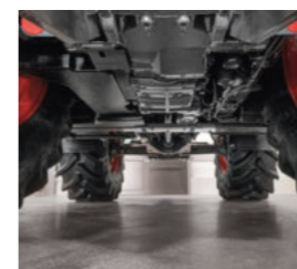
■ Bis zu 50 cm echte Bodenfreiheit – weil ohne tiefbauende Teile wie Anschläge oder Leitungen.
