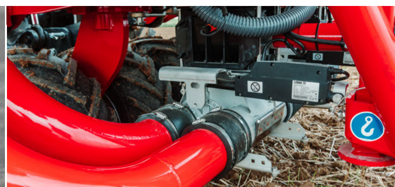
Optionale elektrische Halbseitenschaltung ermöglicht präzises SectionControl am Vorgewende oder Hindernissen
