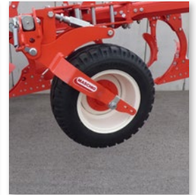
Transport- und Tiefenführungsrad mit hydraulischer Dämpfung
