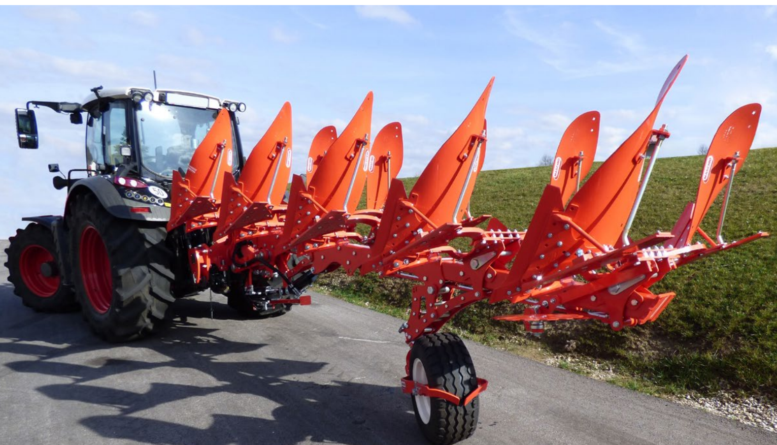
Transport- und Tiefenführungsrad mit hydraulischer Dämpfung
