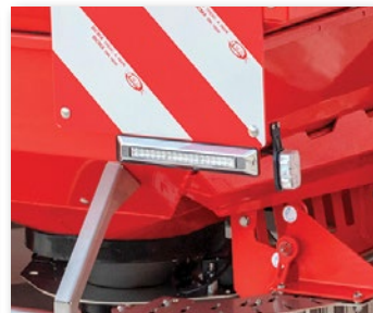
LED-Rückstrahler-Set (serienmäßig auf PRIMO EW - E/ EW-ISOTRONIC)
