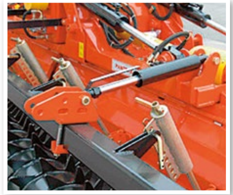
Hydraulische Klappung (Pantera)
