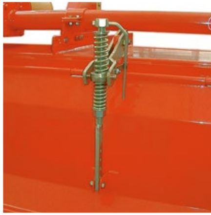
Federspindel zur Verstellung der Bodenklappe
