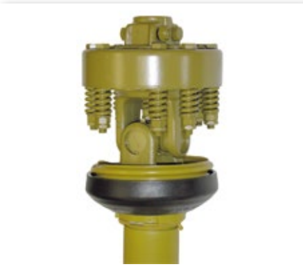
Walterscheid-Gelenkwelle mit Rutschkupplung
