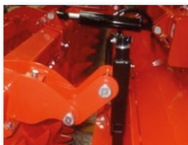
PANTERA: Mechanische Spindel zur Verstellung der Planierhaube (ist am Walzenrahmen fixiert)
