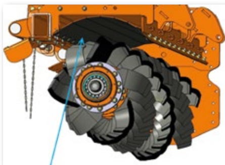
Kit Anticlogging: Für den Einsatz in feuchten und klebrigen Böden
