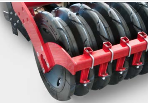
Der FarmFlex Packer verfügt über effektive und robuste Abstreifer für einen störungsfreien Lauf.
