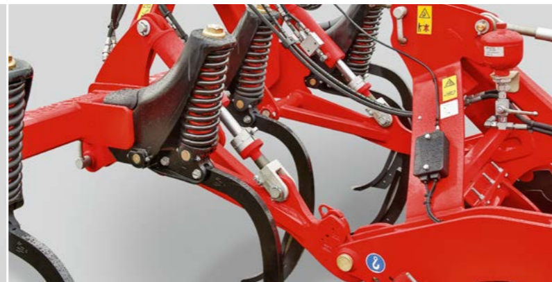
Mono TG: Optimal zur tiefen Lockerung. TerraGrip Zinken mit schmalen LD (low disturbance) Scharen lockern den Boden tief, befördern aber keine groben Kluten nach oben.
