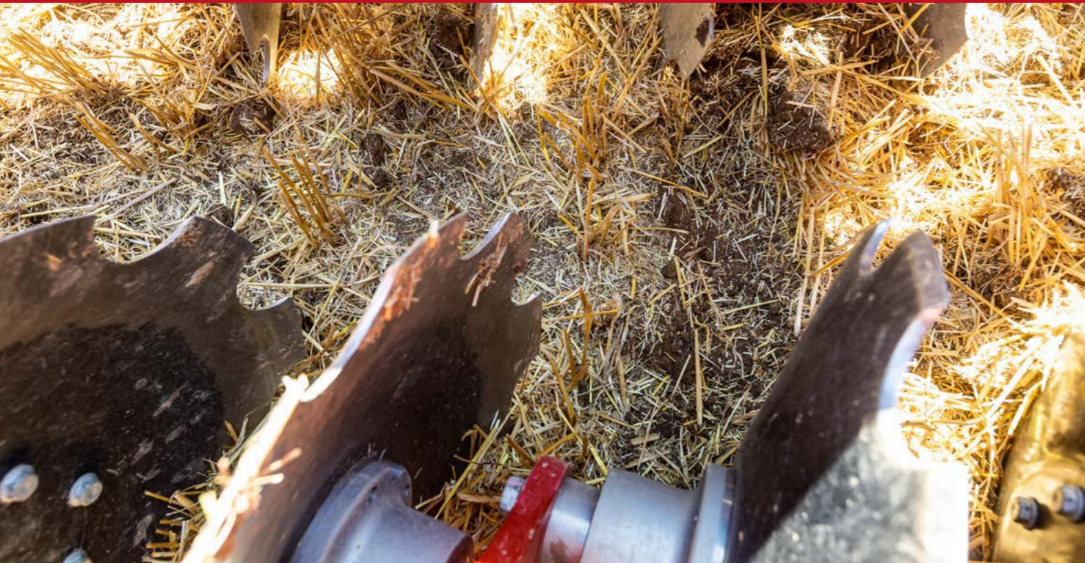
Durch die breite Gummilagerung gleichbleibende Arbeitsqualität auch unter härtesten Bedingungen. Jede Scheibe hält ihren Arbeitsbereich.
