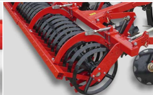
RollCut Packer Gute Oberflächenstruktur auf mittelschweren, steinfreien Böden
