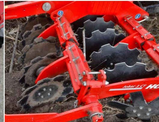
Paarweise Anordnung der Scheiben für maximalen Durchgang
