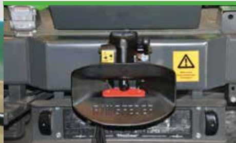
Automatische Anhängerkupplung mit Druckluftanschluss
