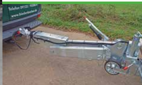
Höhenverstellbare Zugdeichsel mit Zugöse oder Kugelkopfkupplung
