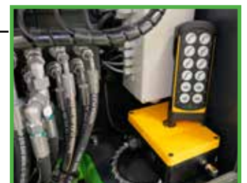
Funkfernsteuerung Div. hydraulische Funktionen via Funk einstellbar
