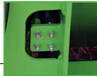
Zentrale Abschmierpunkte Einfache und schnelle Schmierung
