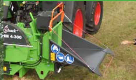
Einzugsabschaltung durch Stahlsicherungsseil
