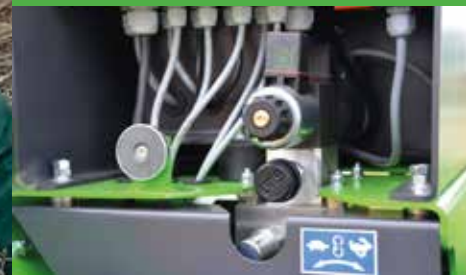
Einzugs-geschwindigkeit stufenlos regelbar durch Mengenteiler
