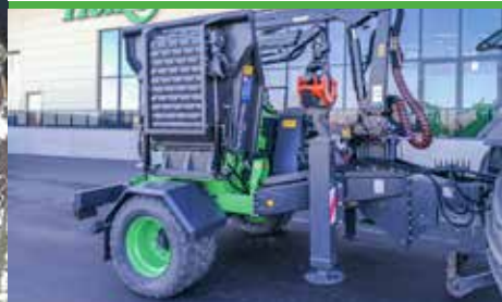
Zugdeichsel höhenverstellbar 520, 620, 900 und 1000 mm (*)2
