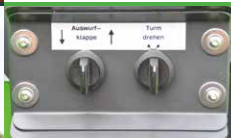
Elektrische Turm- und Klappenverstellung
