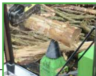
Kegelspalter Zum Vorspalten für nahezu jeden Stammdurchmesser
