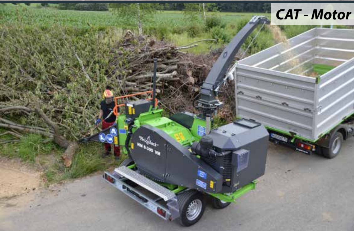
Höhenverstellbare Zugdeichsel mit Zugöse oder Kugelkopfkupplung
