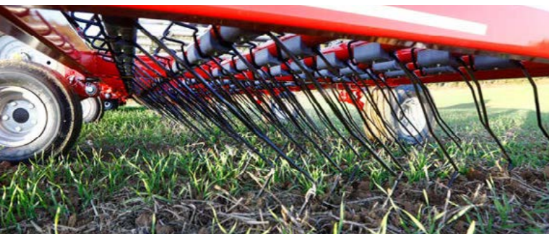
Maximaler Durchgang durch Rahmenhöhe und Federn oberhalb Rahmen
