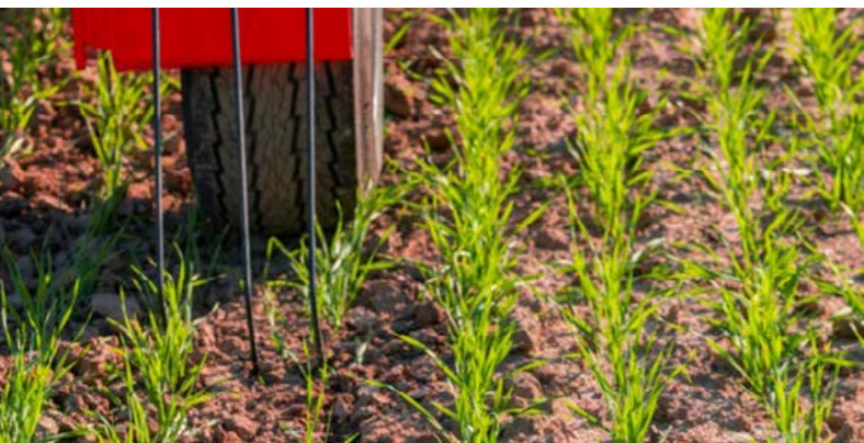
Nachlaufstriegel für die hinteren Stützräder
