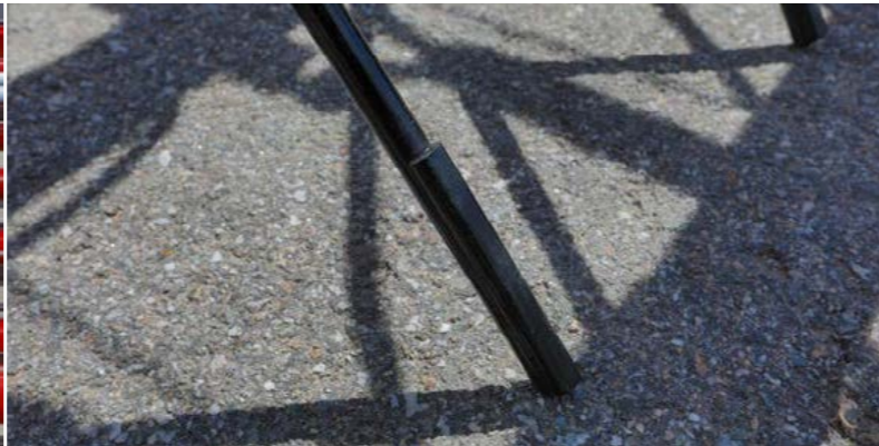
Striegelzinken mit 60 mm langem Hartmetallschutz
