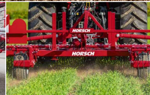
Stützräder variabel auf die Spurweite einstellbar
