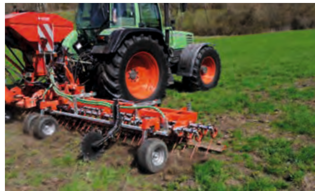
Die Nachsaat wird breitwürfig zwischen die Striegelzinken hineingeblasen und eingestriegelt.
