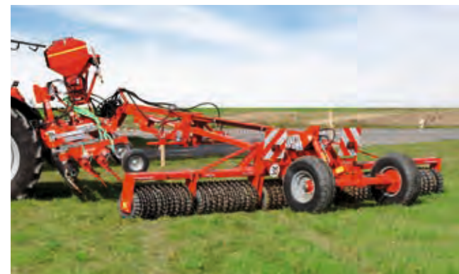
Alle Walzensterne in einer Flucht: kein schädliches Radieren beim Wenden
