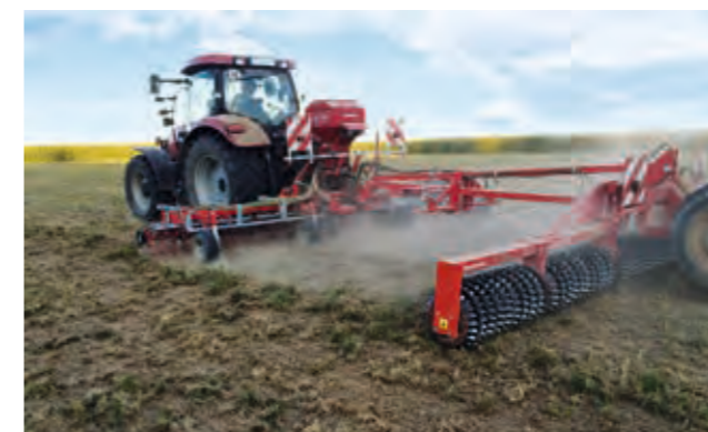
Nachsäen mit 25 - 35 kg/ha und Anwalzen in einem Arbeitsgang
