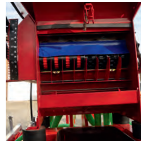
Geteilter Sätank mit zwei getrennten Kammern für grobkörnige und feinkörnige Sämereien. Beide Kammern können in der Dosierung getrennt voneinander eingestellt und abgedreht werden!
