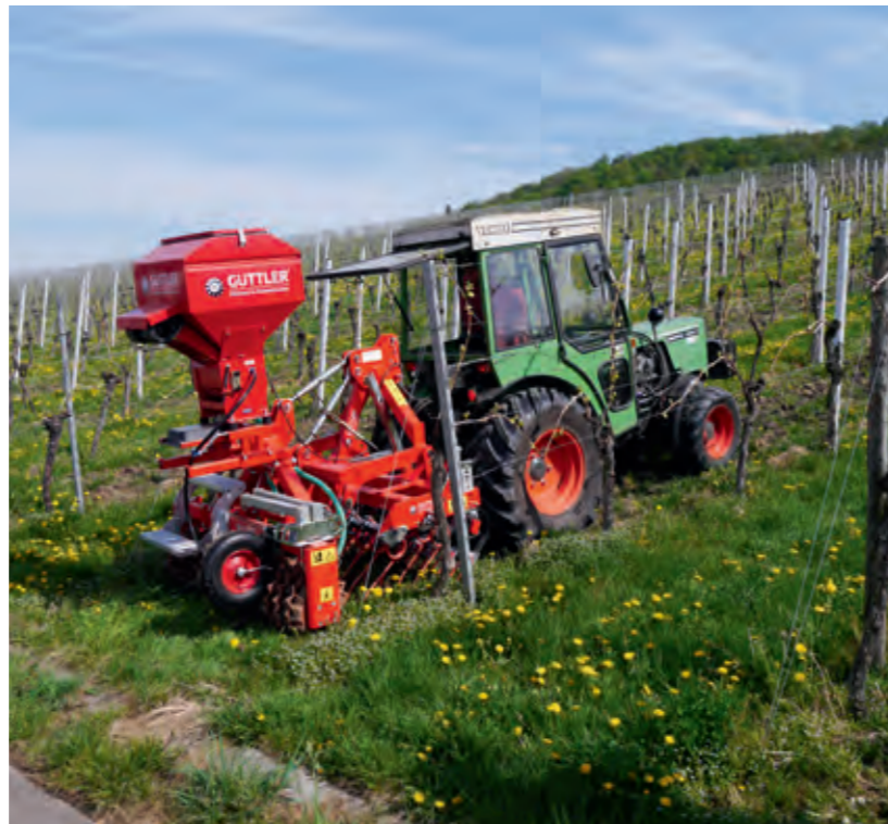
Striegel und Walze mit Sägerät zur Neuansaat von Begrünungen bzw. zur Pflege und Übersaat von bestehenden Begrünungen
