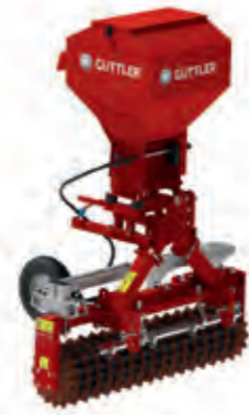
Striegel und Walze mit Sägerät zur Neuansaat von Begrünungen bzw. zur Pflege und Übersaat von bestehenden Begrünungen
