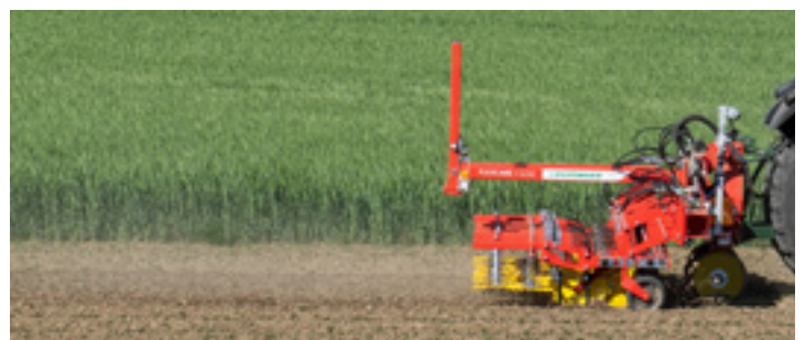
Das Hackgerät Flexcare kann flexibel und werkzeuglos angepasst werden
